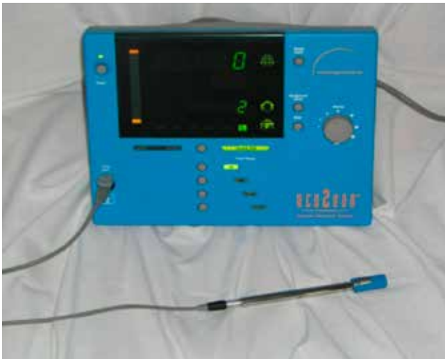
Рис. 5. Использование портативного гамма-детектора NEO2000
